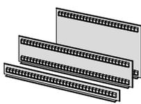
En chapa de acero galvanizada. Sirven para la subdivisión longitudinal y transversal de los cajones, con ranuras cada 17 mm para insertar en el perímetro interior de los cajones. Pueden fijarse al fondo perforado de los cajones.
